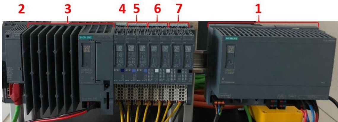
Abbildung 1-1: Aufbau Siemens SIMATIC Open Controller (ET200SP 1515SP)
