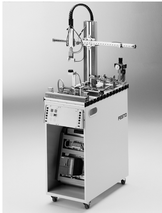
Station Handhaben mit Wagen, Bedienpult und SPS Board
