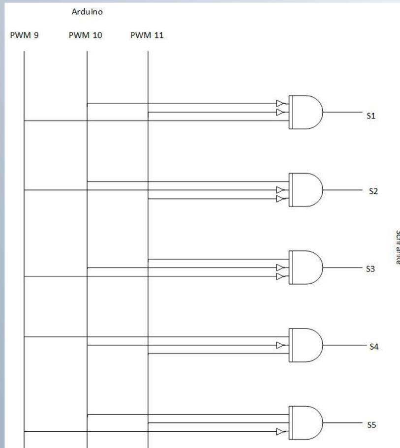
Abhängig von den Ausgängen des Mikro-Controllers, durch Verwendung von Gattern, auf  $2^n$  Ausgänge erweiterbar.
